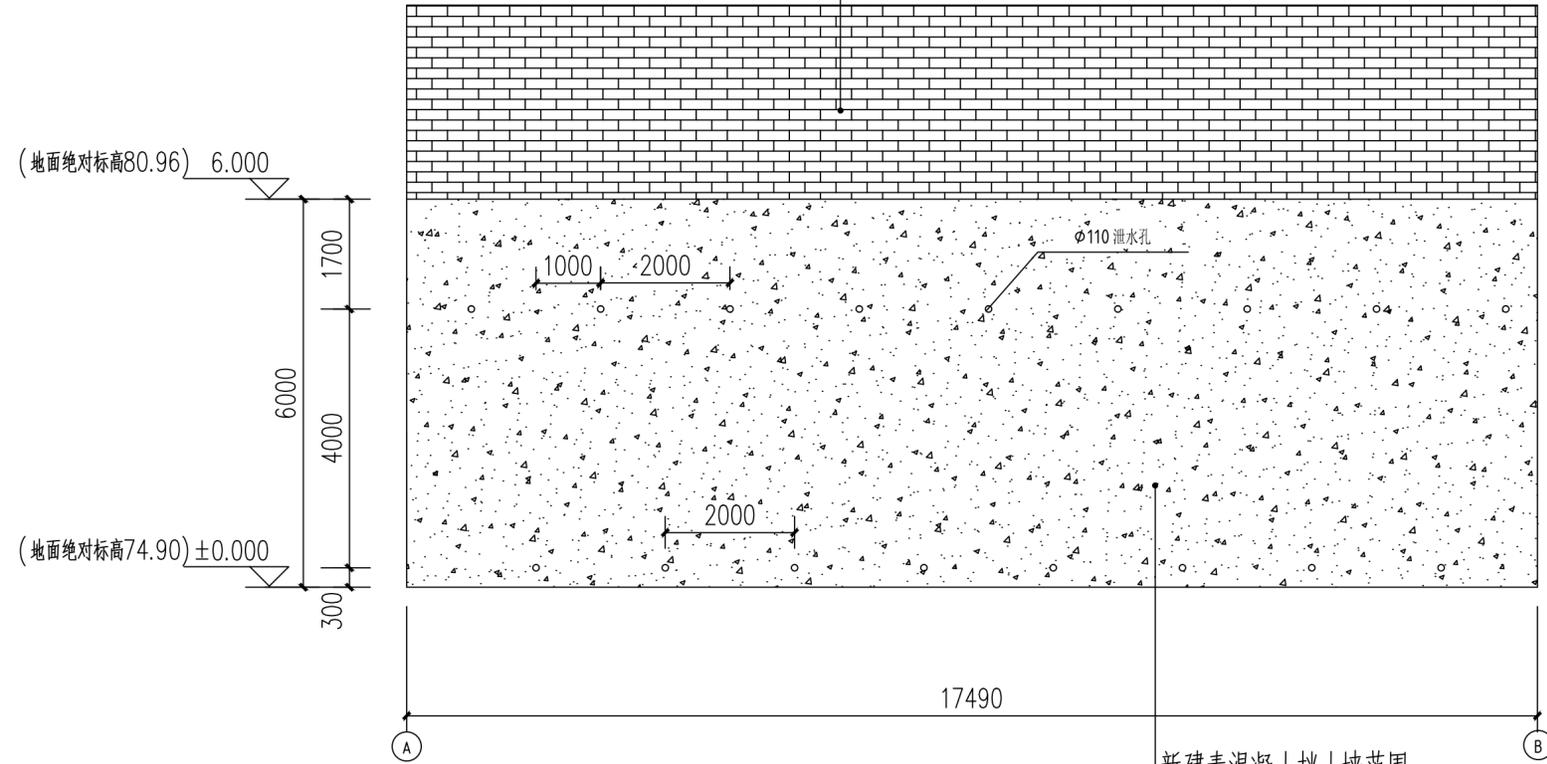
A-B挡土墙立面图面1:100
