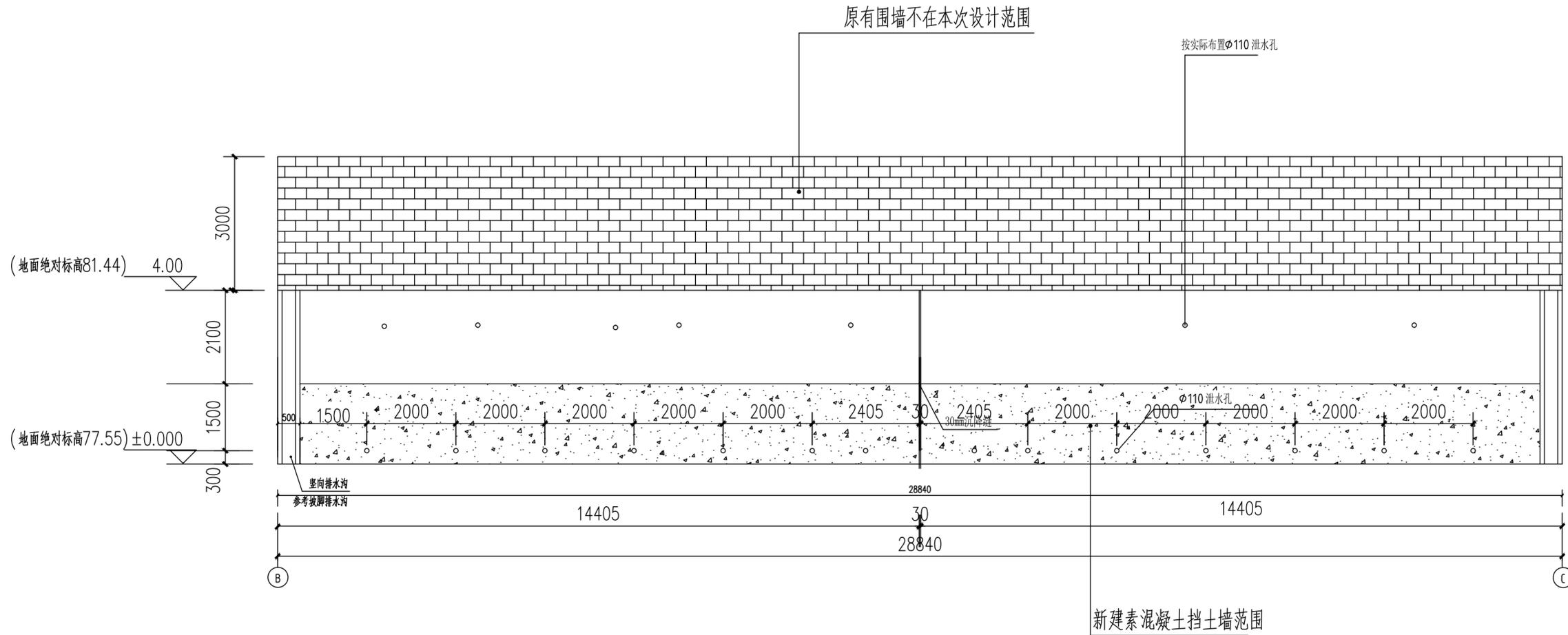
B-C断挡土墙立面图面1:100
