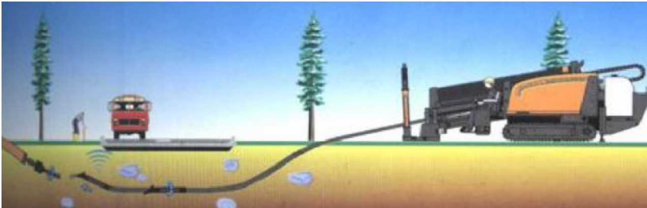
图 8-8 水平定向钻施工情况
