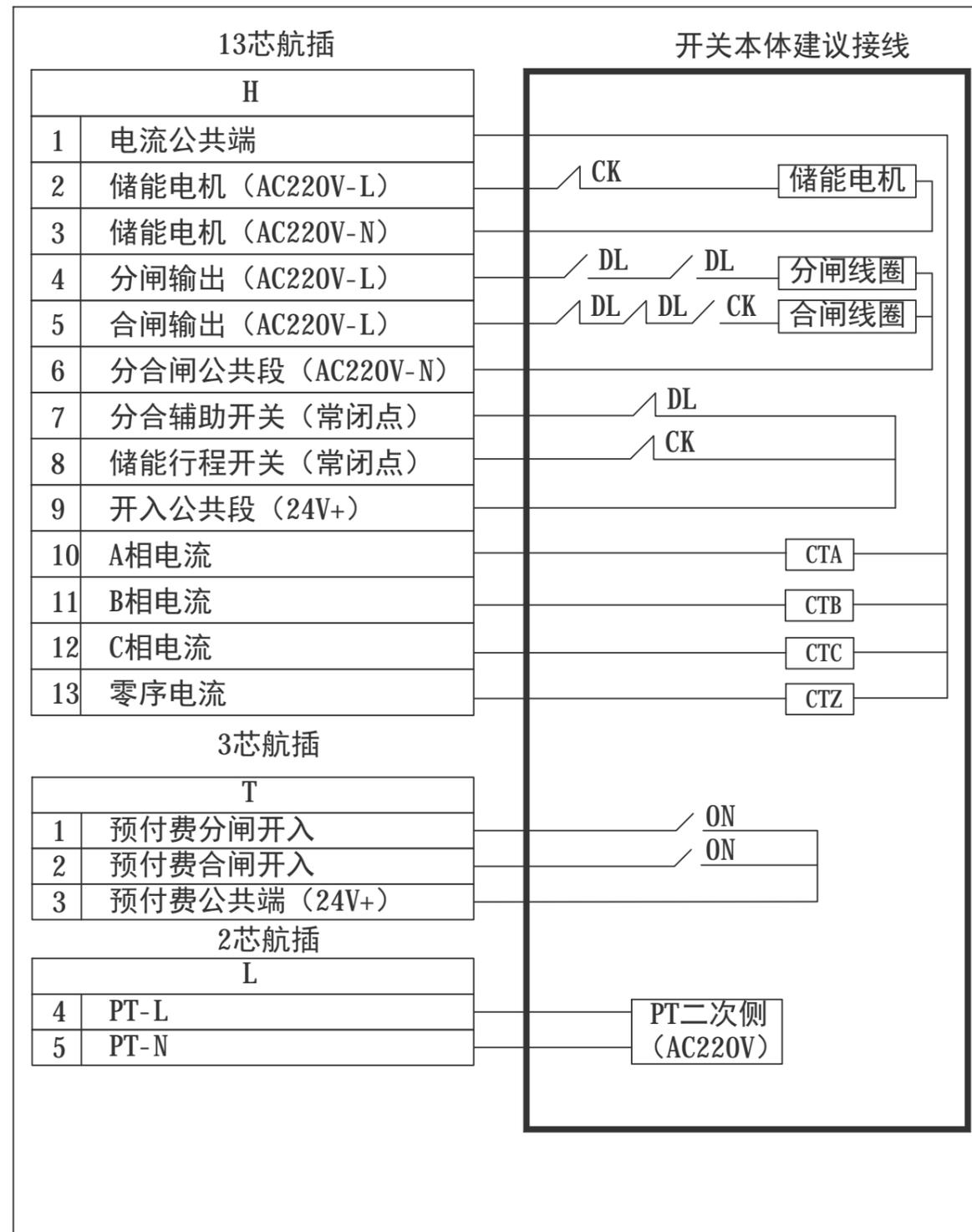
备注：CTA：A相电流 CTB：B相电流 CTC：C相电流 CTZ：零序电流
