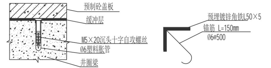
橡胶缓冲层安装大样图
