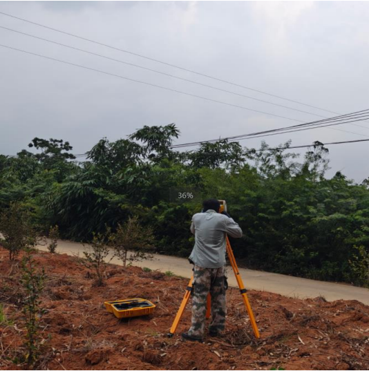
图 6-3 高压线测量
