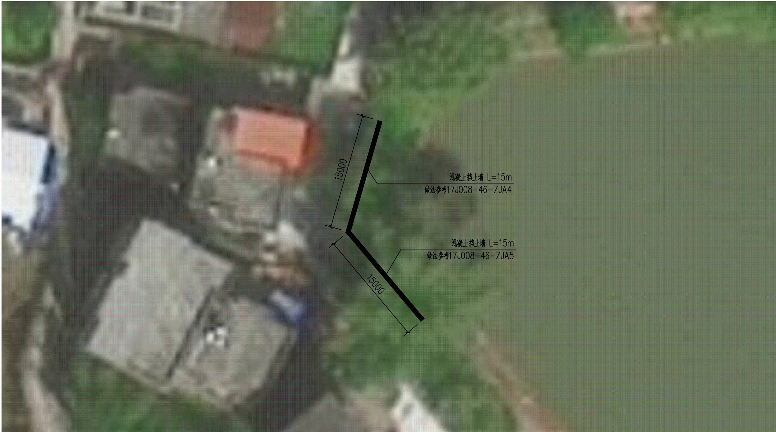
① 新建混凝土挡土墙平面图 1:300
