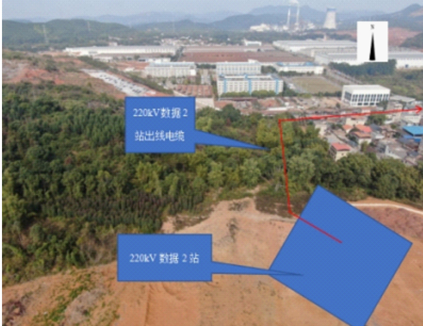
图2.2 220kV数据2站电缆通道图
