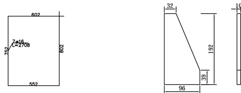
基础箍筋大样图 1:20
