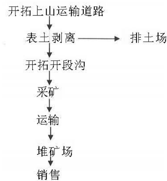
图5-1 采矿工艺流程示意图
